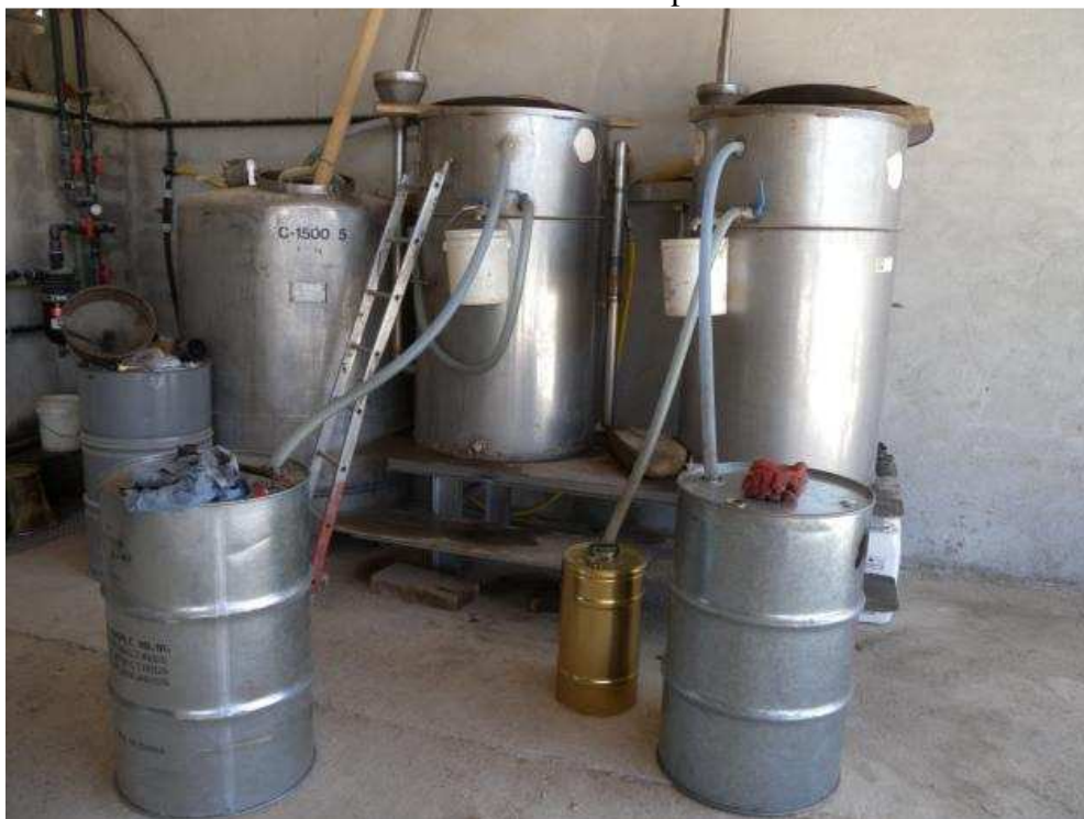
Photo 1 Unité de distillation de lavandes sur le plateau de Valensole
