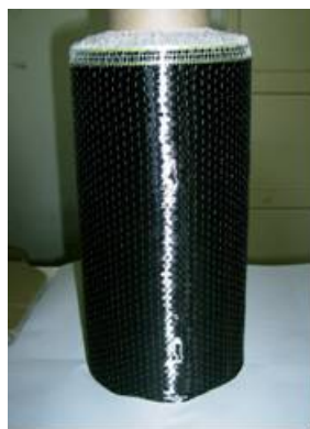
Figure II.1. 3: Tissu unidirectionnel en fibres de carbone de type SikaWrap-230 C/45
