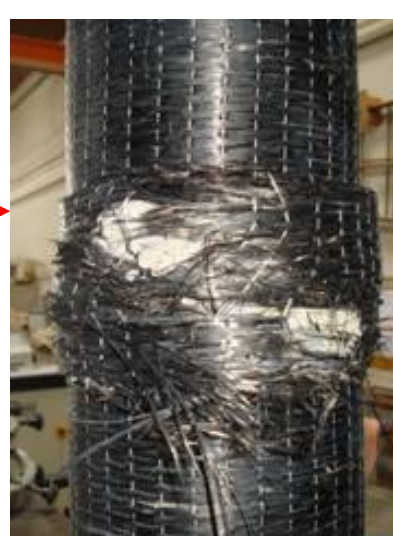
Figure II.3. 19 : Colonnes (Ø155x1000 mm) confinées avec des matériaux composites PRFC après rupture
