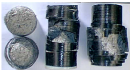
Cylindres en béton confiné par 4 couches PRFC
