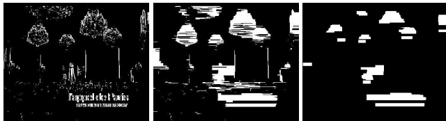
(b) Sobel filter. (c) Dilatation and erosion step. (d) Filtering step.
