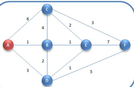
Graphe origine avec des poids sur les arêtes indiquant la distance entre les 2 sommets
