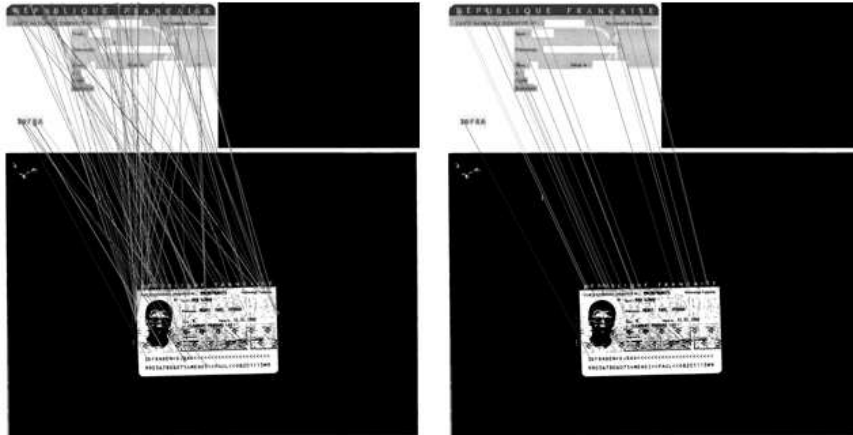
Figure 7. Estimation du modèle géométrique avec RANSAC. À gauche : il reste 78 mises en correspondance après filtrage par unicité, angle et échelle. À droite : le meilleur modèle trouvé par RANSAC valide 16 mises en correspondance.
