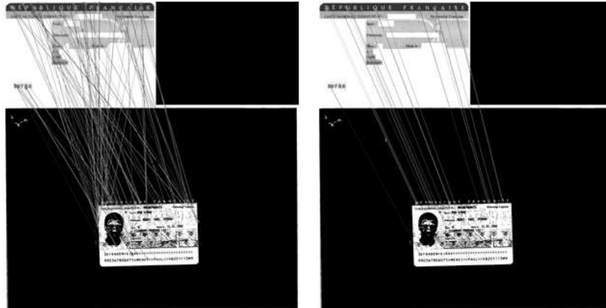
Figure 7. Estimation du modèle géométrique avec RANSAC. À gauche : il reste 78 mises en correspondance après filtrage par unicité, angle et échelle. À droite : le meilleur modèle trouvé par RANSAC valide 16 mises en correspondance.
