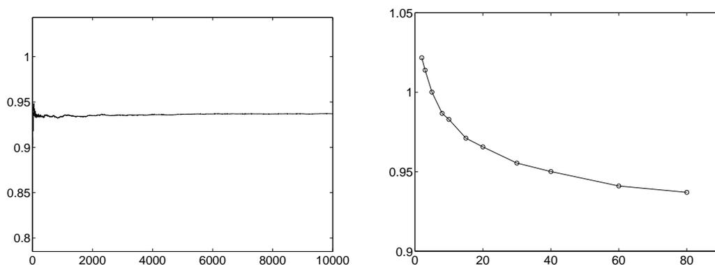
**Figures 2** : Convergence en moyenne d'ordre deux de la suite de variables aléatoires  $\Gamma$  pour  $\delta=0.3$ . Figure 2-a (gauche) : Graphe  $n_s \mapsto \{E\{\Gamma^2}\}^{1/2}$  pour  $n=80$ . Figure 2-b (droite) : Graphe  $n \mapsto \{E\{\Gamma^2}\}^{1/2}$  pour  $n_s=10000$
