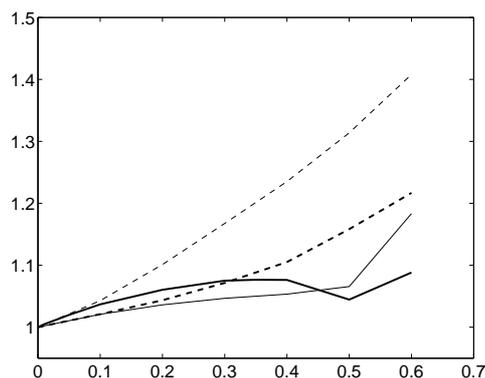
**Figure 5** : Valeur de  $\gamma^*$  en fonction de  $\delta$  pour  $n=80$  et  $n_s=10000$  et pour les 4 cas :  $f_1=1.42(Hz)$  (trait continu épais),  $f_1=2.43(Hz)$  (trait continu mince),  $f_1=3.18(Hz)$  (trait tireté épais),  $f_1=3.79(Hz)$  (trait tireté mince). Graphes de  $\delta \mapsto \gamma^*(\delta)$  tel que  $P\{\Gamma \leq \gamma^*\}=0.95$ .
