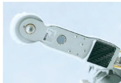
Photo 1b - Le CNR4 (composante réfléchie), instrument permettant les mesures du rayonnement visible et infrarouge.
