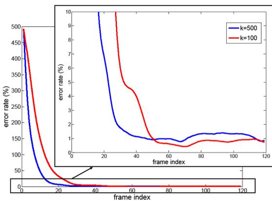
FIGURE 3 – Erreurs constatées pour les cartes de profondeur  $D$  estimées par l’observateur asymptotique (20) appliqué au flot optique brut  $V_{HS}$  pour différents gains  $k$ . Le bruit est fixé à  $\mathcal{N}(0, 1)$ .
