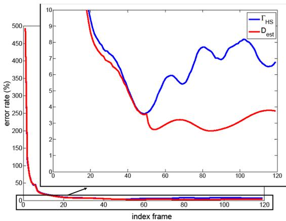
FIGURE 6 – Erreur constatée pour l'estimation directe de  $1/\Gamma_{HS}$  (bleu), décrite en 3.2, et de  $D$  (rouge) par l'observateur asymptotique (23) filtrant  $\Gamma_{HS}$ . Le bruit est  $\mathcal{N}(0, 20^2)$ .
