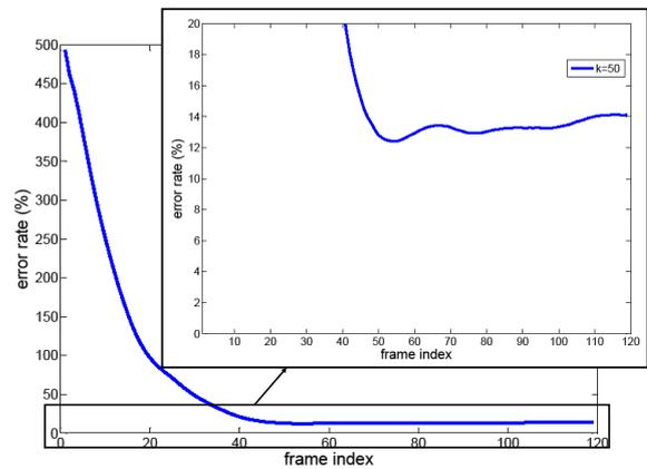
FIGURE 4 – Erreur constatée pour la carte de profondeur  $D$  estimée par l’observateur asymptotique (20) filtrant le flot optique brut  $V_{HS}$ . Le bruit de l’image est fixé à  $\mathcal{N}(0, 20^2)$ .
