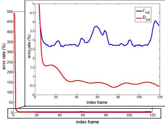
FIGURE 5 – Erreur constatée pour l'estimation directe de  $1/\Gamma_{HS}$  (bleu), décrite en 3.2, et de  $D$  (rouge) par l'observateur asymptotique (23) filtrant  $\Gamma_{HS}$ . Le bruit est  $\mathcal{N}(0, 1)$ .
