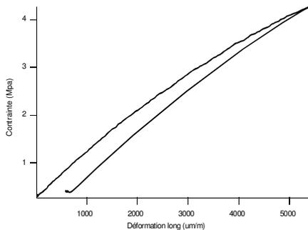
Figure 3a : Courbe de traction sur la moyenne cannelure sens MD
