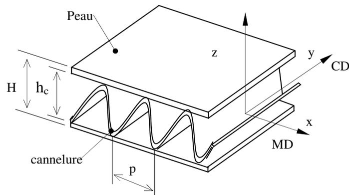
Figure 1 : Géométrie du carton ondulé
