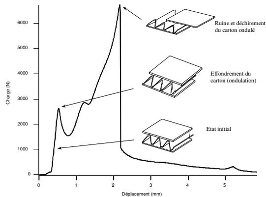
Figure 4 : Courbe charge déplacement de la moyenne cannelure sens MD
