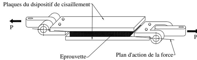
Figure 2 : Montage de cisaillement (bloc shear).
