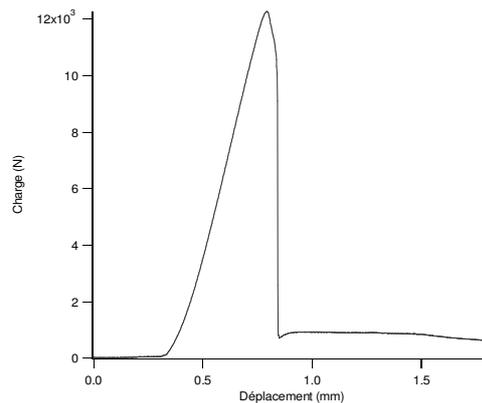
Figure 5 : Courbe charge déplacement de la micro cannelure sens MD
