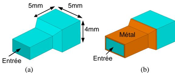
Figure 3. Usinage de l'antenne dans la mousse (a). Revêtement métallique de la mousse (b)
