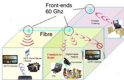
Figure 1. Principe de la Radio sur fibre (RoF)
