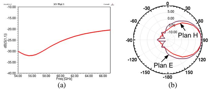
Figure 4. Adaptation (a) , diagramme de l'antenne (b).
