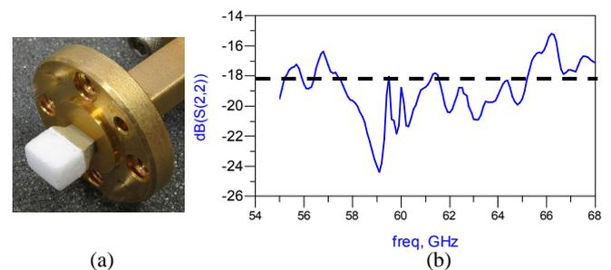
Figure 5. Photographie (a) , adaptation de l'antenne (b).
