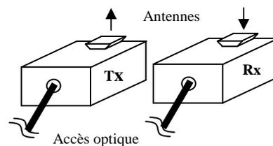
Figure 6. Intégration de l'antenne
