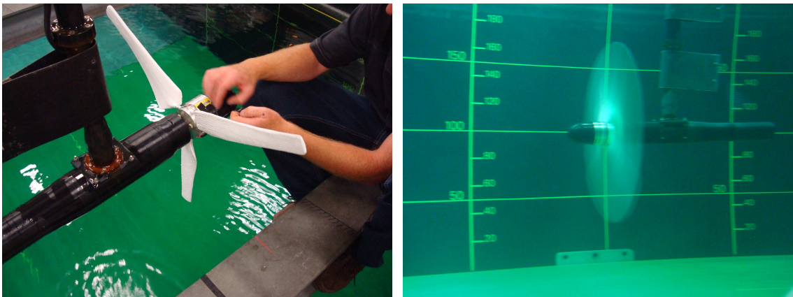
Fig. 13. Essais sur pales composites instrumentées au bassin.
