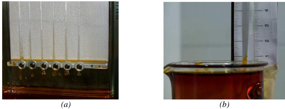
Fig. 3 Montage permettant de suivre la progression capillaire verticale (a) du gel de bougie et (b) de l'huile d'olive.
