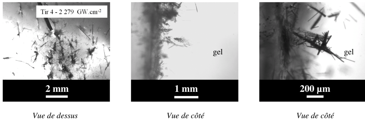
Fig. 5. Vues microscopiques au travers d'un collecteur en Varagel des fibres éjectées issues d'une cible de composite 4 plis choquée à 2\ 279\ \text{GW}\cdot\text{cm}^{-2} (Tir 4). Sur les vues de côté, l'entrée des fragments est observée de la gauche vers la droite au travers du collecteur, la zone plus claire correspondant au gel.
