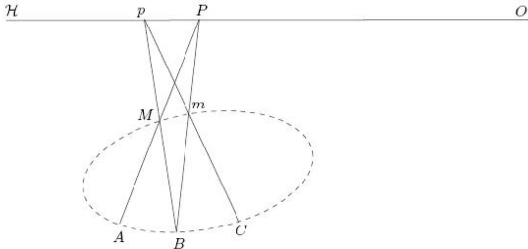
On peut répéter ce processus : on trace la droite (Am), elle coupe (HO) en q. On trace ensuite les droites (Bq) et (CP) dont le point d'intersection n se trouve de nouveau sur l'ellipse recherchée. Ce mode de construction point par point et à la règle seule a un intérêt pratique en dessin : la connaissance des points m, n, etc. sert de guide pour tracer commodément l'ellipse en question à main levée.
