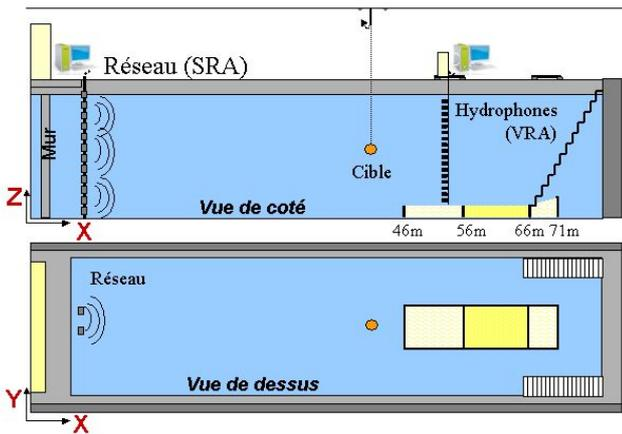
Figure 2: configuration expérimentale : vues de côté et dessus
