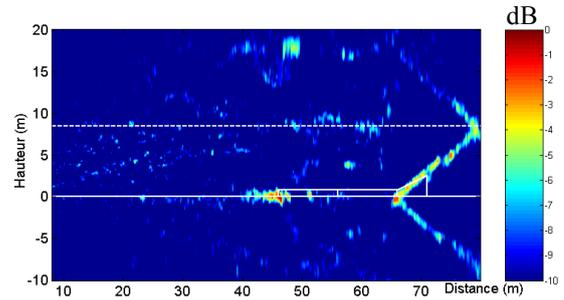
Figure 4 : Rétro-propagation numérique en espace libre du premier vecteur singulier obtenue pour une fenêtre temporelle glissante
