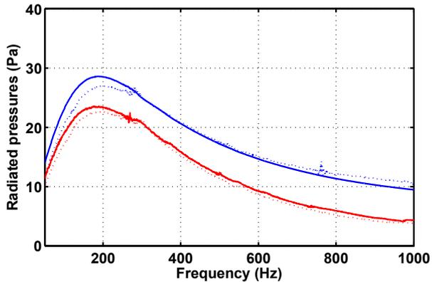
FIGURE 6 – Pressions rayonnées par la cellule hybride pour une tension de 1 V.  $p_c^+$  : rouge,  $p_c^-$  : bleu. Mesure : pointillés, "modélisation" : trait plein.
