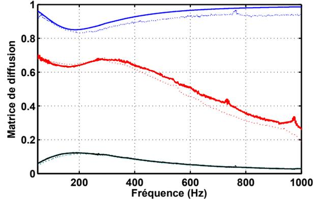
FIGURE 5 – Matrice de diffusion de la cellule hybride en circuit ouvert.  $D_{11}$  : rouge,  $D_{22}$  : bleu,  $D_{12}$  : cyan et  $D_{21}$  : noir. Mesure : pointillés, "modélisation" : trait plein.
