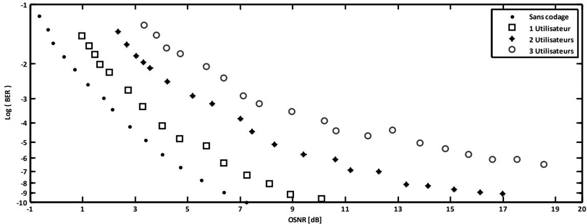
FIG. 4 : Mesure du taux d'erreurs binaires : sans codage et en configurations multi-utilisateurs après transmission via 20 km de fibre à faible dispersion ( $4.1 \text{ ps.nm}^{-1}.\text{km}^{-1}$ ) et faible pente de dispersion ( $\leq 0.05 \text{ ps.nm}^{-2}.\text{km}^{-1}$ ).
