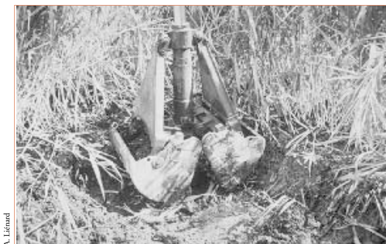
▲ Photo 1 – Enlèvement des boues par benne preneuse dans les lits de séchage expérimentaux de Bourg-Argental.
