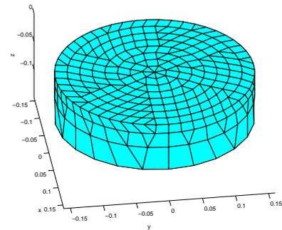
FIG. 8: Maillage utilisé pour modéliser une source concentrique
