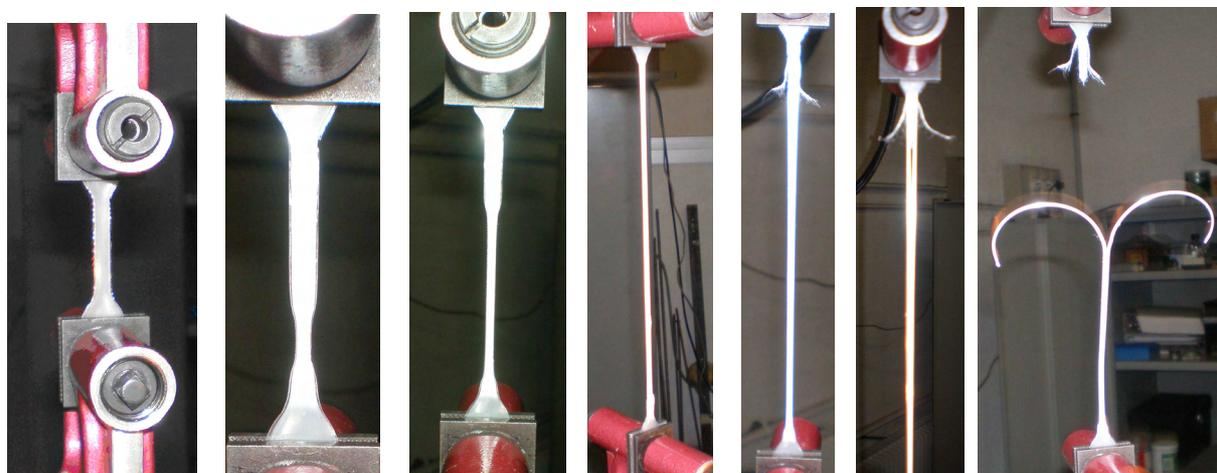
Fig. 3 – Essai de traction sur une éprouvette de PP/EVA03/Si N20 hydrophile
