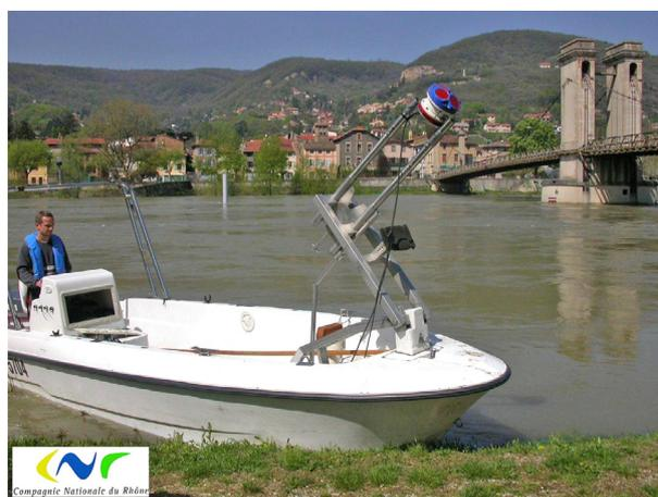
**Figure 1 : bras articulé pour le déploiement d'un aDcp solidaire d'un bateau (photo CNR)**
