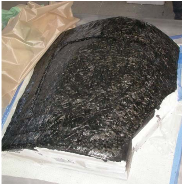
Fig. 4. Moule HexTOOL™ pour élément de structure d'hélicoptère (source : CES – Courtesy of ATN International).
