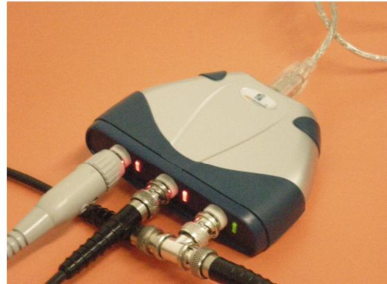
Figure 3 : L'oscilloscope USB (DS1M12 "Stingray")
