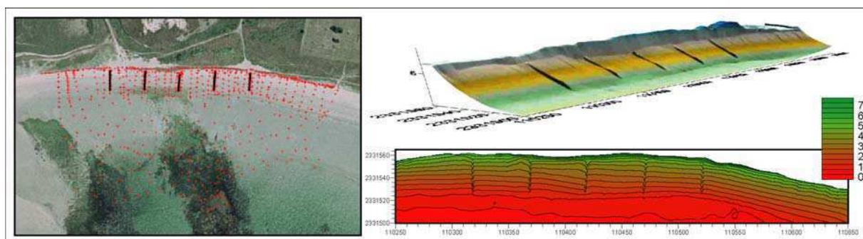
Figure 6 : Procédure de relevé topo-morphologique allant de la saisie de points topographiques sur le terrain, à la construction d'un MNT, à la réalisation d'une carte topographique en isolignes
