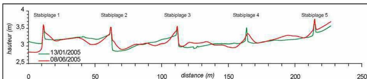
Figure 3 : Evolution du profil longitudinal de la plage recoupant les cinq Stabiplate® dans leur partie médiane entre le mois de janvier et de juin 2005
