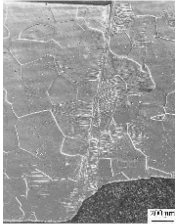
Figure 5 : cisaillement adiabatique dans un alliages de titane (TA6V) (source DGA/DCE/Centre Technique d'Arcueil)
