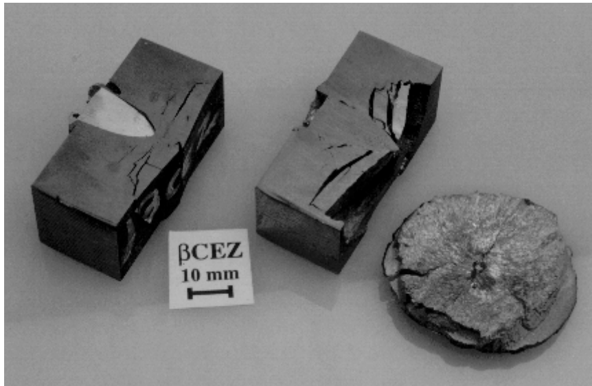
Figure 6 : comportement de deux alliages de titane face à un impact
