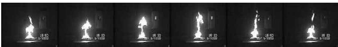
Figure 1 : séquence vidéo issue de l'observation d'une flamme d'acétone à 10 m (mode pulsant) Hauteur moyenne de flamme : 38 cm, largeur de flamme ~12 cm
