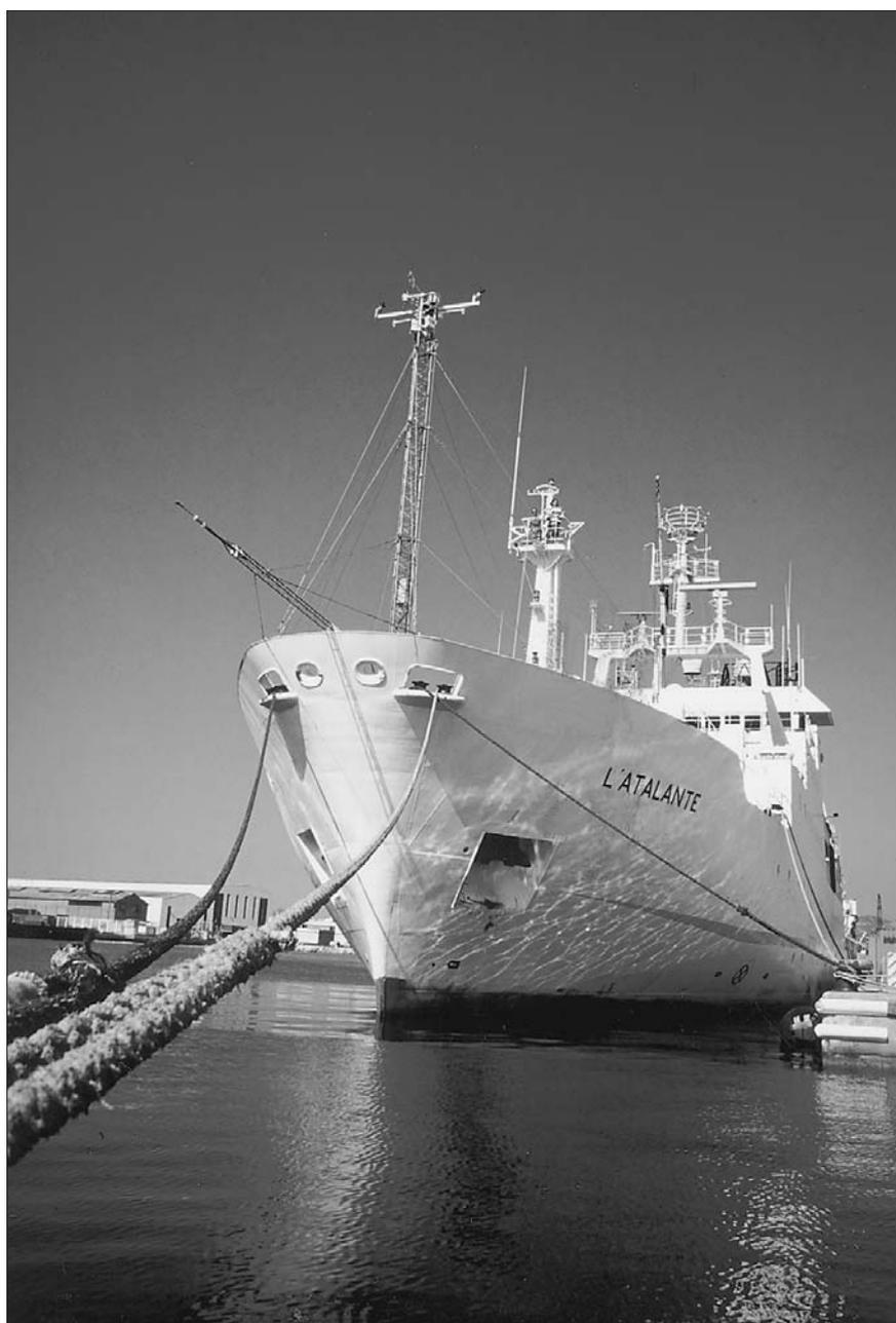
L'Atalante au quai de l'Ifremer, à La Seyne-sur-Mer. À l'avant, le mât instrumenté et la perche permettant une mesure de rayonnement non perturbée par la coque. (Photo G. Lachaud)
