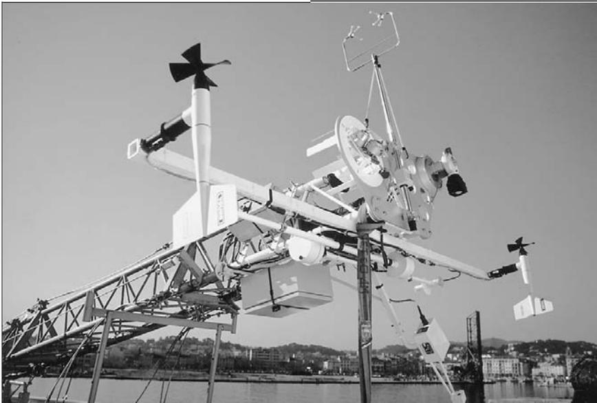
La tête de mât et ses différents capteurs avant l'installation du dispositif à la verticale. On distingue deux anémomètres-girouettes et un anémomètre sonique 3D, en haut de l'image (Lachaud, 1998).
