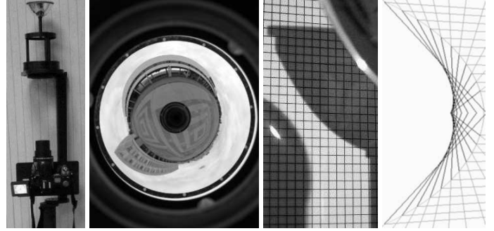
FIG. 5 – De gauche à droite : le miroir Kaidan “360 One VR” et l'appareil photo Nikon “Coolpix 8700” (monté sur un monopode), le champ de vue (360° horizontalement et environ 50° au dessus et en dessous du plan horizontal, lorsque la caméra pointe vers le ciel), la silhouette du miroir et sa caustique pour z^p = 50\text{cm} .
