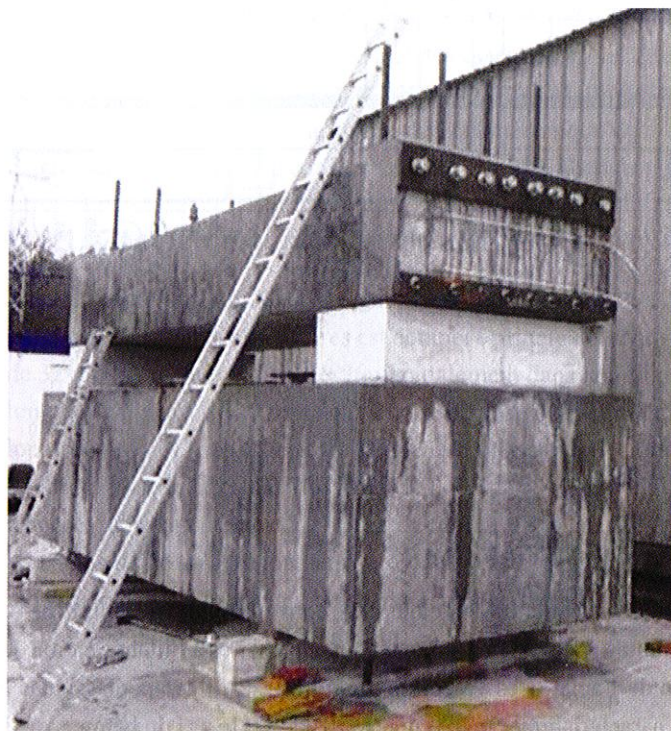
figure 3 Photo du montage de l'ensemble {poutre + bâti}.
