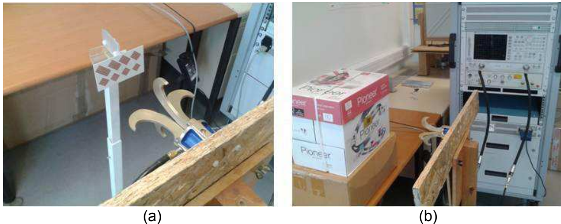
Fig. 5.34 (a) Photo du tag dépolarisant à dipôle en court-circuit à 10 cm de l'antenne de mesure (b) Photo du tag à double C positionné sur un carton rempli de feuilles de papier. Dans les deux cas, l'antenne utilisée est à double polarisation. Sa fréquence de fonctionnement est comprise entre 2 et 32 GHz.
