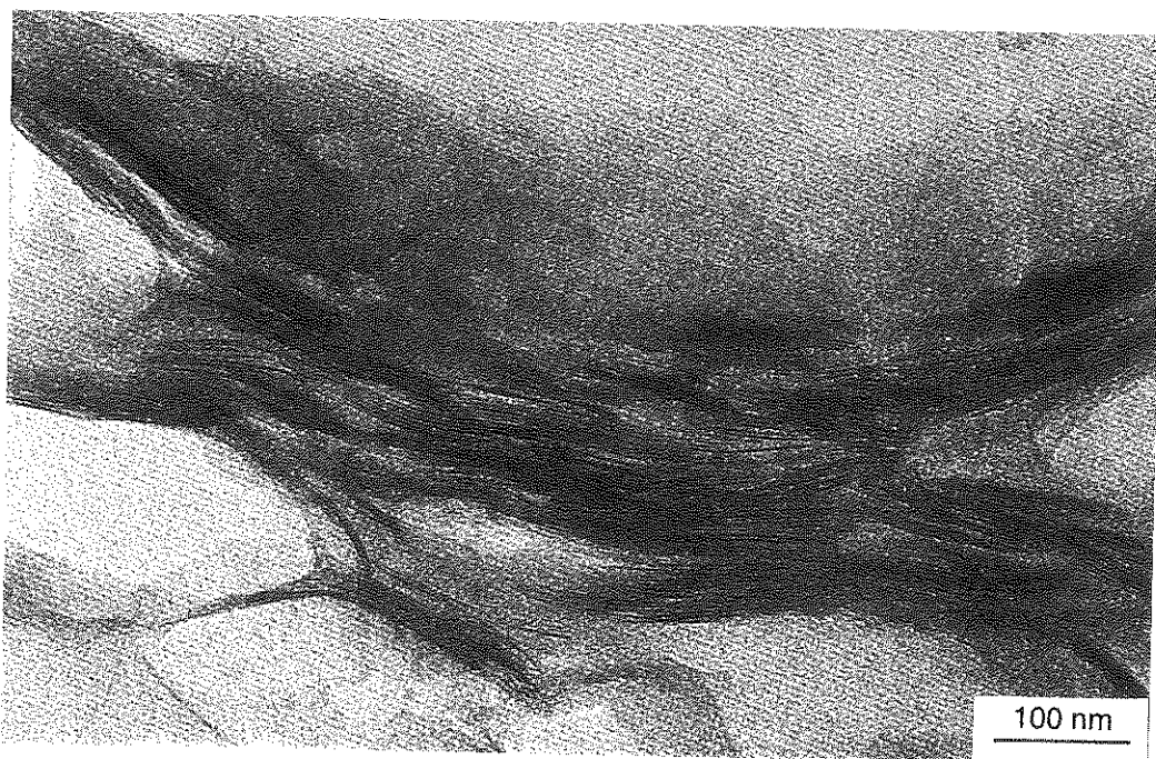
Fig.26 - Particule caractéristique d'une montmorillonite Ca (photo A.M. JAUNET)
