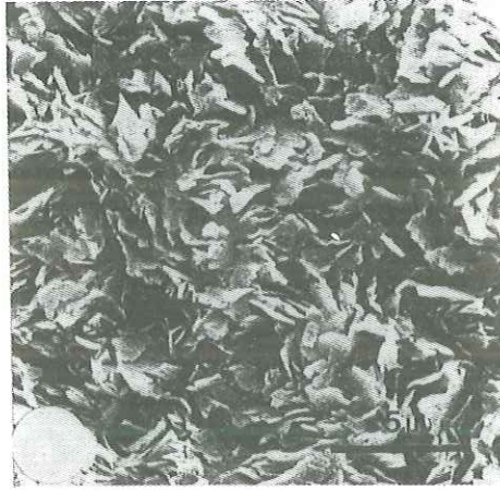
Figure 1. Photo en microscopie à balayage montrant l'aspect interne de grains de glauconie. Noter l'arrangement typique en lamelles.
