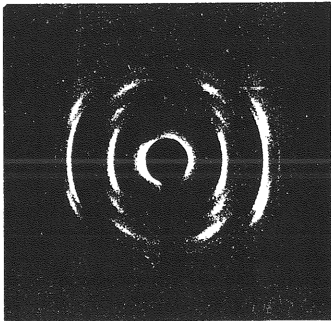
Figure II 11 : Diffraction standard obtenue avec la Montmorillonite de Garfield.
