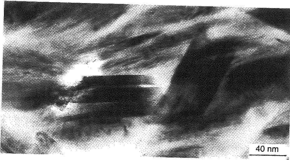
Fig.21 - Particule caractéristique de la fraction 2 µm d'une illite de sol
