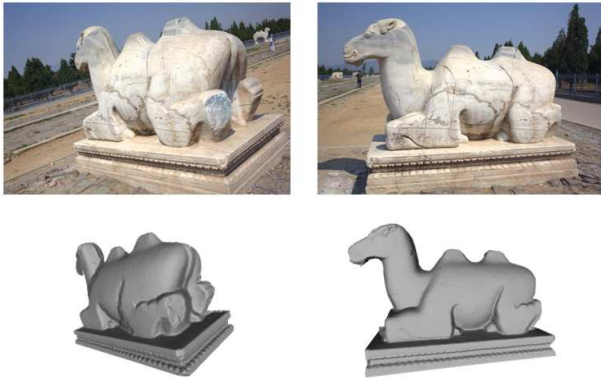
FIGURE 11 – Données en entrée de l’algorithme : un couple d’ images avec leurs profondeurs associées (gauche : vue 1, droite : vue2).
