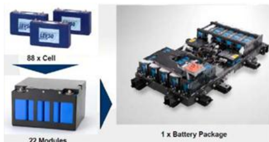
Figure 7 - Illustration des composants d'une batterie lithium de véhicule électrique (EV). Exemple de la Mitsubishi i-MiEV (CEIS,2011, d'après www.mitsubishi-motors.com )
