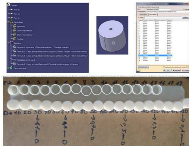
Figure 7–Plan d'expérience relié au modèle CAO et récapitulatif des pièces tests après impression et nettoyage
