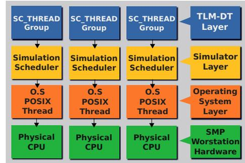
Fig. 2. SystemC-SMP Architecture
