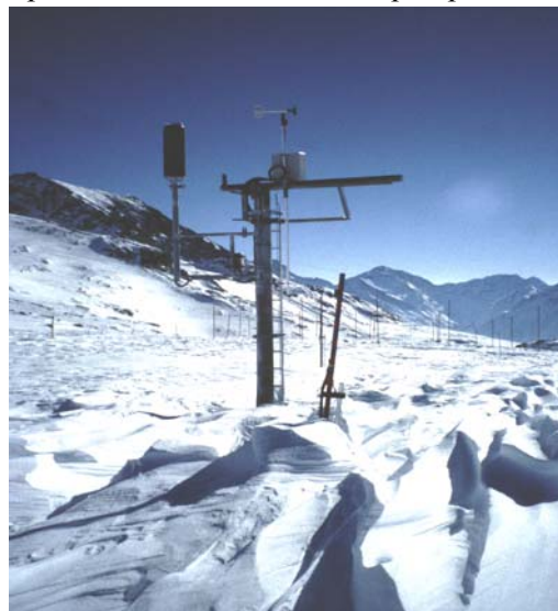
Figure 2 : Station météorologique avec en le arrière plan le réseau de perches à neige
