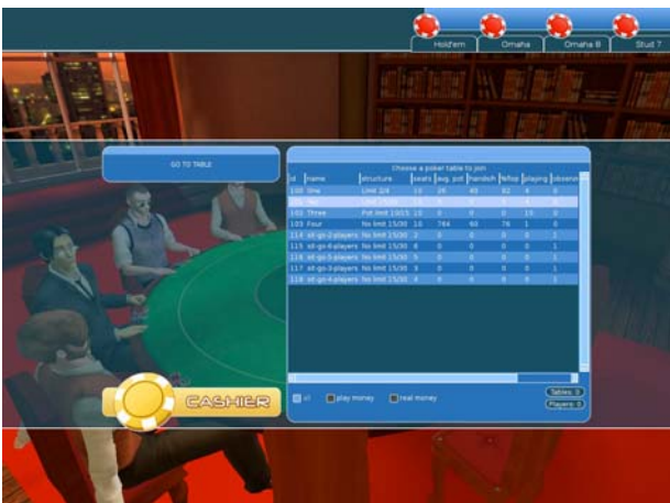
Figure 6 : Les éléments d'interface 2D de Poker3D (en bleu) sont gérés par GTK+ et intégrés grâce à Metisse dans la scène OpenGL.
