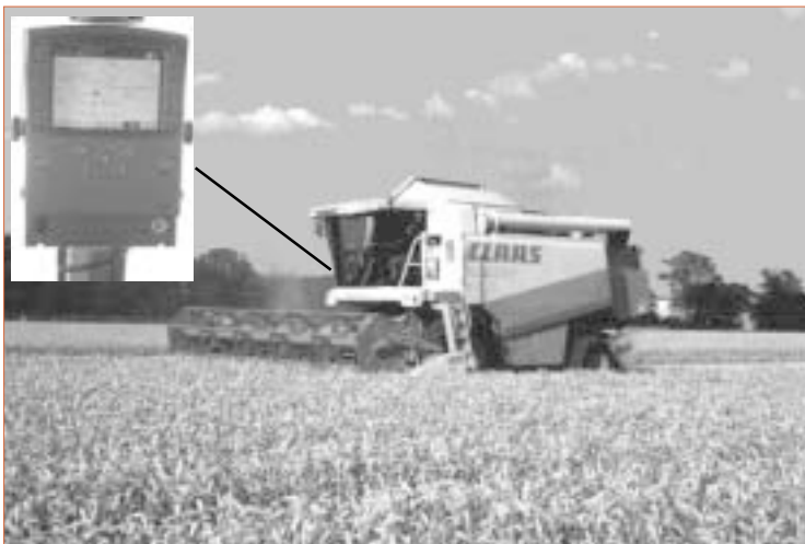
▲ Photo 2. – Moissonneuse-batteuse équipée pour la réalisation de cartes de rendement ; ici, le terminal peut être transféré sur le tracteur pour contrôler la réalisation des applications modulées.
