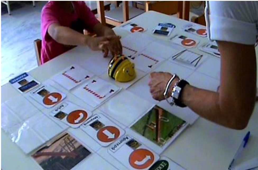
Figure 1 : Programmation tangible du jouet programmable et programme en cartes de commandes
