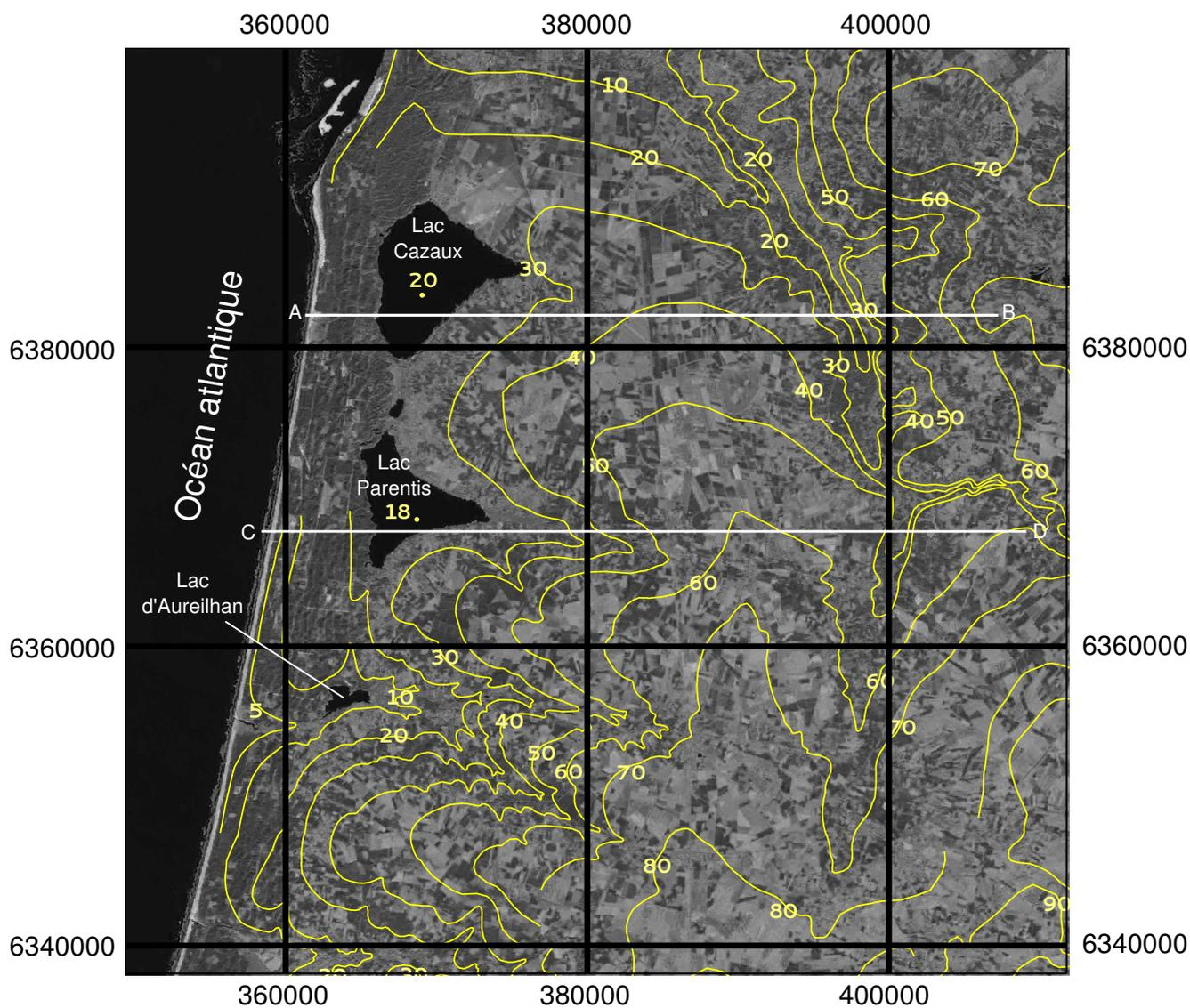
FIGURE 13.8 – Image Landat 8 de la région de Biscarosse sur laquelle sont superposés les isopièzes de la nappe des sables des landes, de Castets et des sables dunaires. La grille de coordonnées des latitudes et longitudes est donnée en mètres. Les cotes sont données en mètres au dessus du niveau de la mer. [4] et SIGES Aquitaine.
