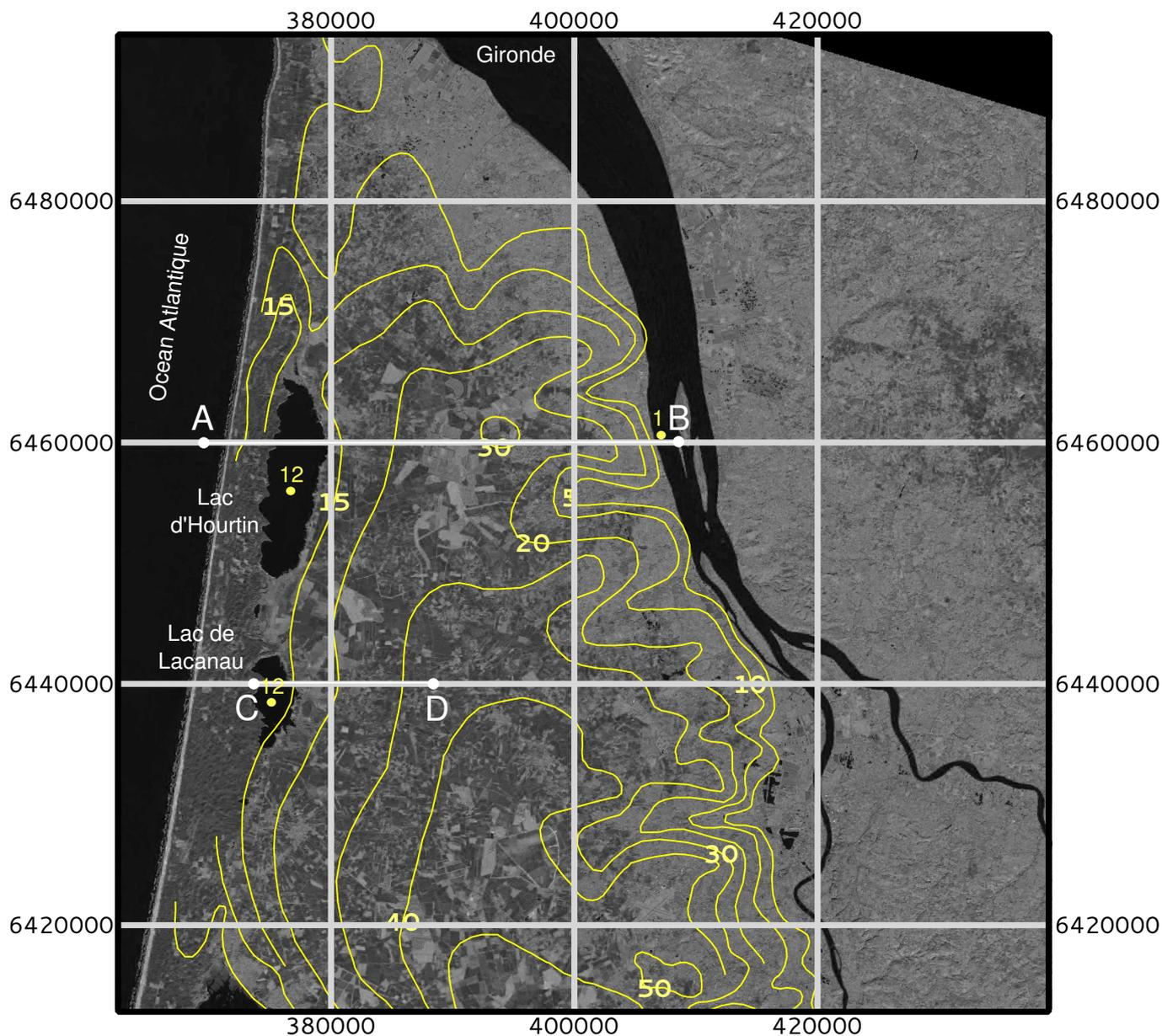
FIGURE 13.5 – Image Landsat 8 de la région des lacs médocains sur laquelle sont superposés les isopièzes de la nappe des sables des landes, de Castets et des sables dunaires. La grille de coordonnées des latitudes et longitudes est donnée en mètres. Les cotes sont données en mètres au dessus du niveau de la mer. source des données : [4] et SIGES Aquitaine.
