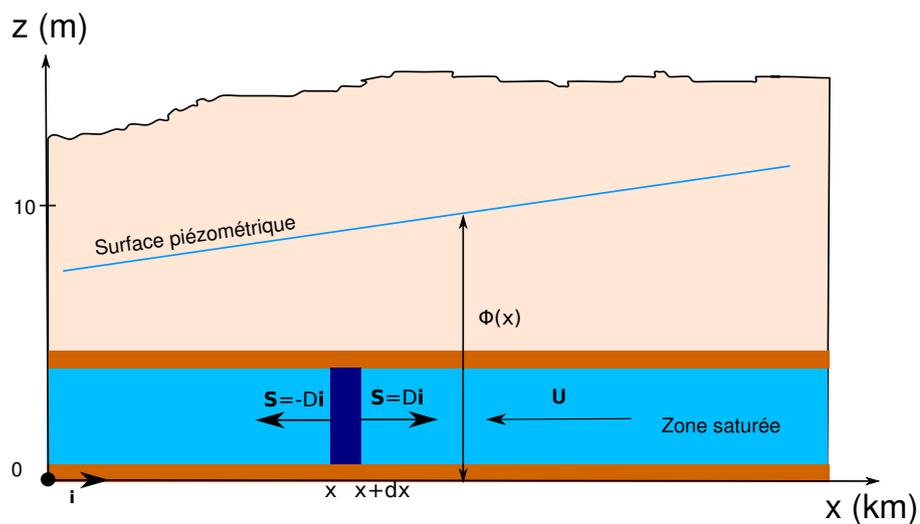
FIGURE 5.2 – Bilan de masse dans une nappe captive
