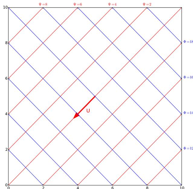
FIGURE 4.2 – Courbes équipotentielles  $K\phi(x) = 10^{-4}(x + 2y) = C_e \text{ m}^2/\text{s}$  (bleu), lignes de courant  $\psi(x, y) = 10^{-4}(2x - y) = C_c \text{ m}^2/\text{s}$  (rouge) et vitesse de l'écoulement. la vitesse est définie par  $\mathbf{U} = -10^{-4}\mathbf{i} - 2 \cdot 10^{-4}\mathbf{j}$ . Elle a pour norme  $\|\mathbf{U}\| = \sqrt{5} \cdot 10^{-4} \text{ m/s}$ .
