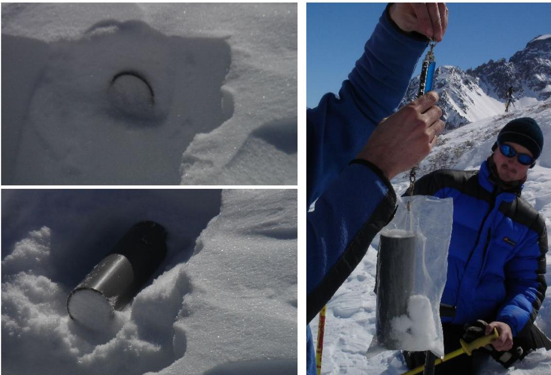
Figure 3.38 Méthode de mesure la masse volumique en statique : Extraction de la neige avec un tube. La masse de la neige de l'échantillon divisée par le volume du tube est la masse volumique (CEMAGREF).
