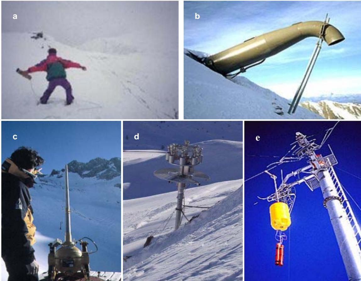
Figure 1.5 Protections actives temporaires : a. Déclenchement manuel (grenade à la main). b. Gazex c. Avalancheur d. Avalhex e. Catex. (Cemagref).
