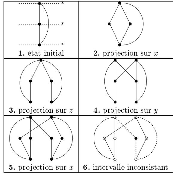
FIG. 3 – Filtrage AC (vue “intervalles”)
