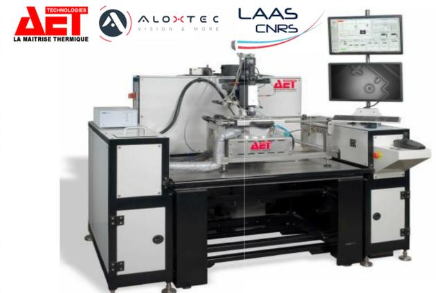
Four d'oxydation industrielle de production de VCSELS commercialisé par AET Technologies / Aloxtec : [alox.aet-technologies.fr](http://alox.aet-technologies.fr)
