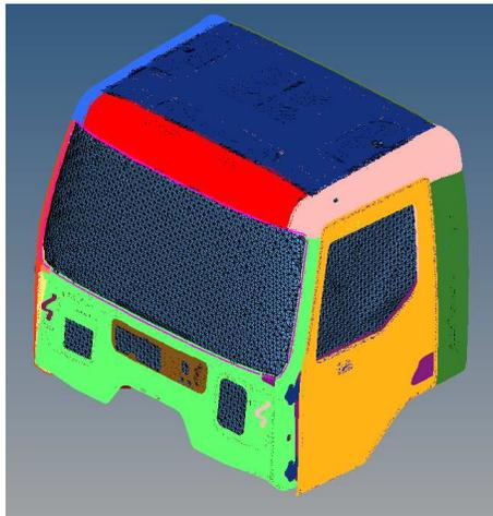
Figure 1: Modèle éléments finis de la cabine et de la cavité acoustique.
