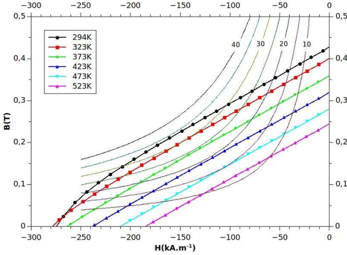
Fig. 6. Courbes de désaimantation, les lignes correspondent aux courbes à  $(BH)$  constant en  $kJ.m^{-3}$ . Au delà de 323 K ( $50^\circ C$ ), le champ coercitif dans le plan  $B(H) \mu_0 H_{CB} = J_R$ .
