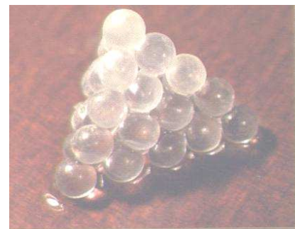
Fig. 1.8 a - Ponts capillaires entre deux grains b - Empilement rigidifié par les forces capillaires
