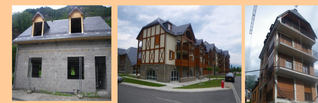
Habitat individuel en maçonnerie agglomérée. Habitat collectif en voiles béton. Habitat collectif en poteaux-poutres
