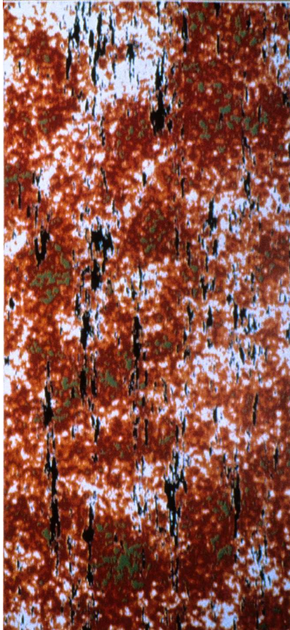
Figure 14-b. Nodules polymétalliques sur le fond du Pacifique Nord. Ssimulation géostatistique sur un champ de 22.5 x 50 km : l'abondance augmente du blanc au rouge puis au vert ; les pentes supérieures à 10% sont superposées en noir. (Extrait de « Stratégie de dragage/Nodule mining strategy », document audio-visuel, Ifremer-Gemonod, 1988)
