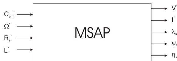
Figure 5. Modèle fonctionnel de la MSAP
