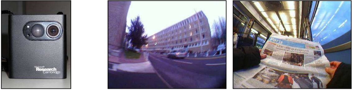
Figure 28 : La SenseCam et des exemples de photos extraites de la séquence d'activité d'une personne
