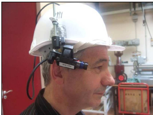
Figure 37 : Prototype de subcam V4-casque
